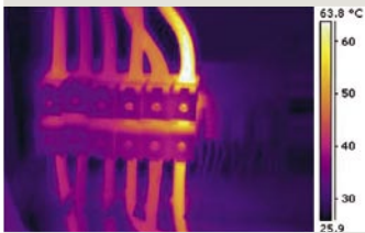
Lose Klemmenverbindung einer Reihenklemme IR Bild von BL Automation GbR
